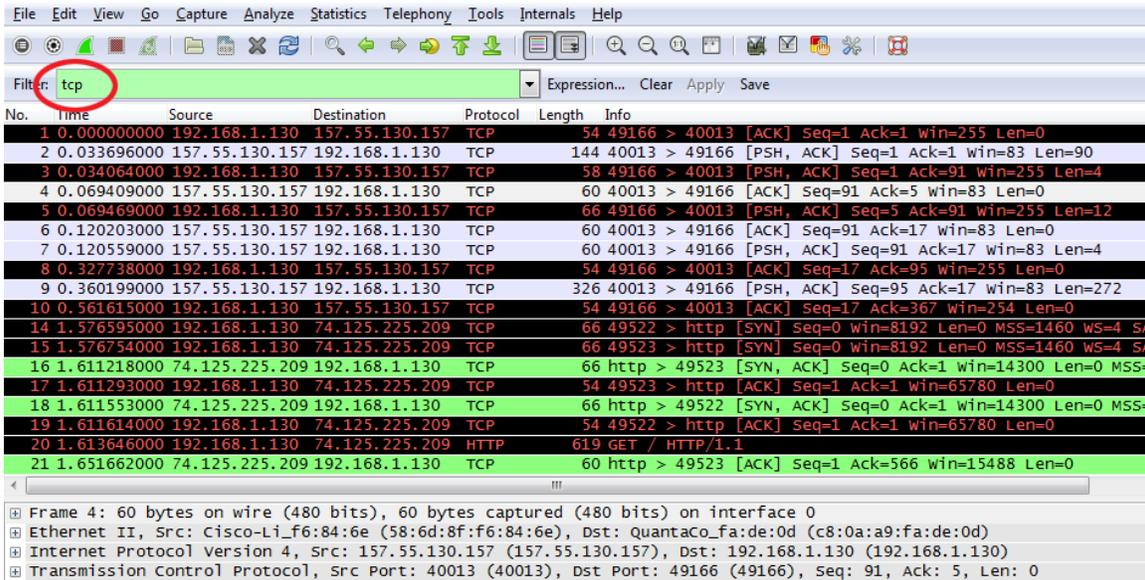
**Étape 3 : Examinez les informations au sein des paquets, y compris les adresses IP, les numéros de port TCP et les indicateurs de contrôle TCP.**
