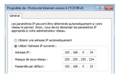
b. Configurez l'adresse IP, le masque de sous-réseau et la passerelle par défaut sur PC-B.
